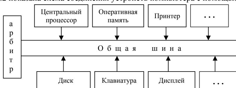
Рис. 15.2. Архитектура компьютера с общей шиной.
