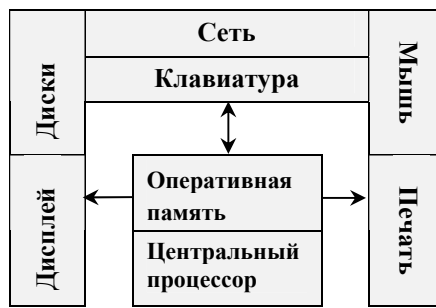
Рис. 14.2. Центральная и периферийная части компьютера.
