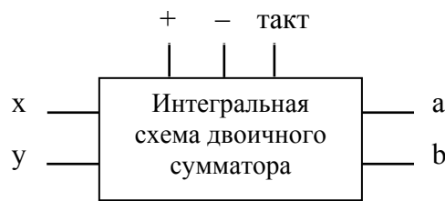
Рис. 2.2б. Интегральная схема двоичного сумматора.
