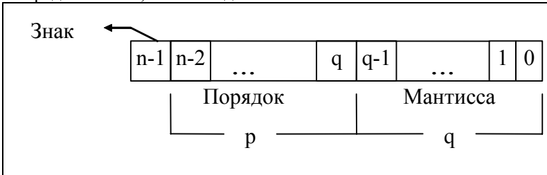
Рис. I.21. Представление вещественного числа в формате с плавающей точкой
